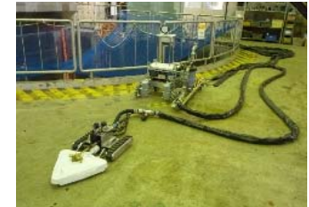
床面除染装置
