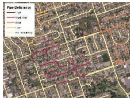
人工衛星データを用いた漏水検知システム
