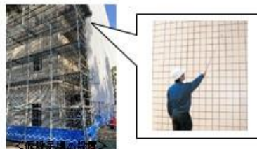
【(一財)日本建築防災協会 提供】 ＜テストハンマーによる打診＞
