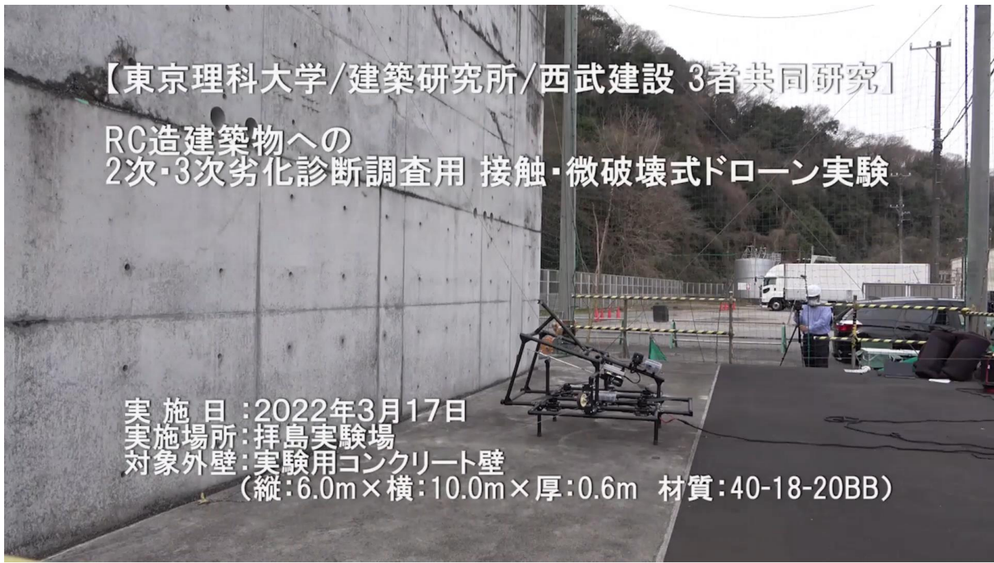
開発したドローンとドリルによる壁面削孔状況
