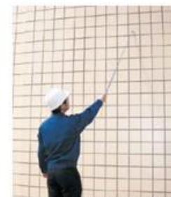
【(一財)日本建築防災協会 提供】 ＜テストハンマーによる打診＞
