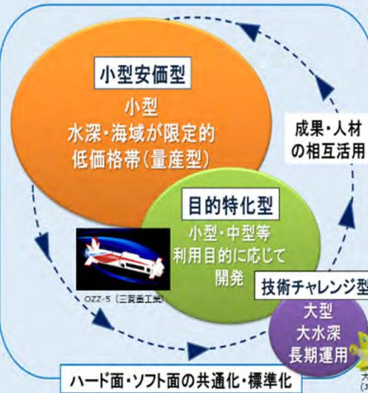
参考図：AUV 3 類型の関係性と規模感
